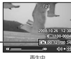
頭出し/コマ送り：一時停止中に**[□]**で先頭のコマを、**[□]**で最後尾のコマを表示します。**[□]**で前のコマを、**[□]**で次のコマを表示します。**(■)**ボタンで再生をはじめます。
