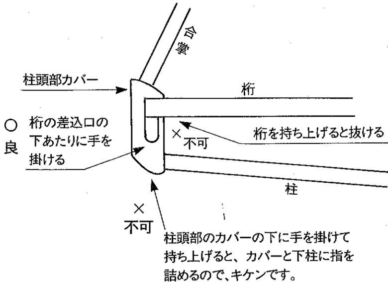
⑩テントは片側ずつ起こしますが、風下の方から起こして下さい。起こした側の柱の方杖（支え腕）を桁にはめ込んで下さい。
